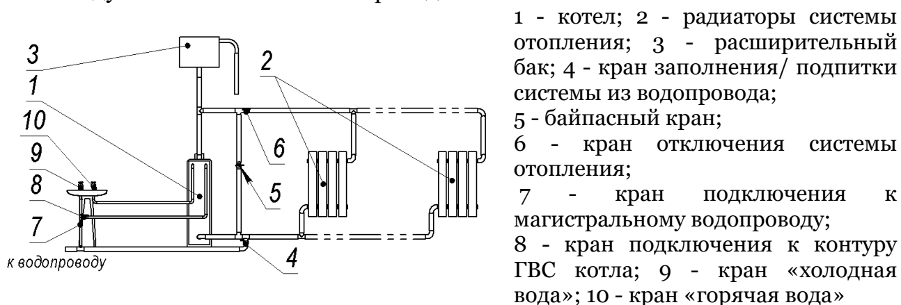
Рис. 10 - Монтаж котла с контуром ГВС в систему с естественной циркуляцией
